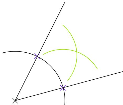
3 Verbinde den Schnittpunkt der beiden Linien mit dem Scheitel des Winkels
