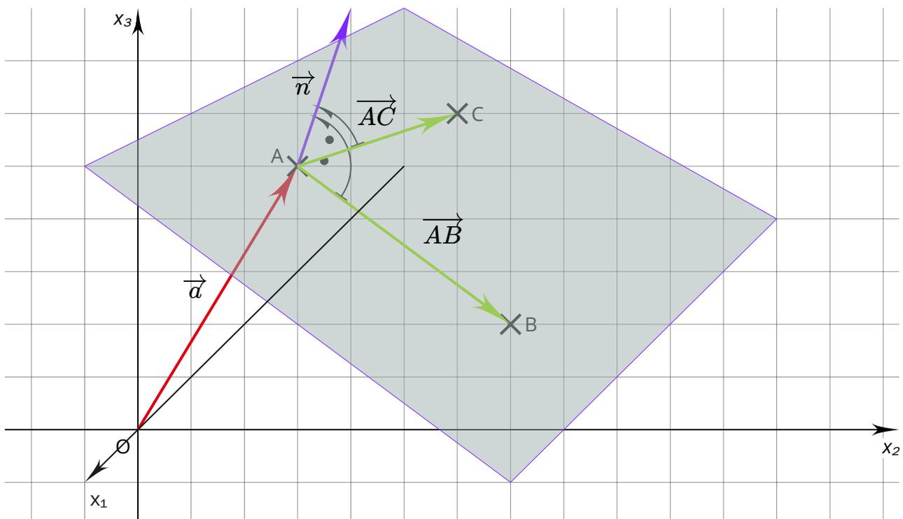
Da das Vektorprodukt der Spannvektoren einen Vektor ergibt, der senkrecht auf der Ebene steht, lässt sich ein Normalenvektor der Ebene als Vektorprodukt der beiden Spannvektoren errechnen:
