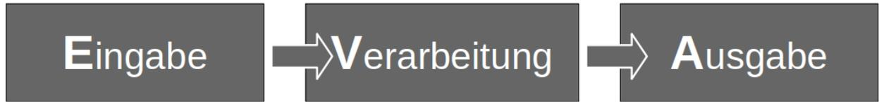
Vereinfacht dargestellt, arbeiten alle Maschinen nach dem Prinzip "EVA" (englisch: IPO model: Input-Process-Output).
