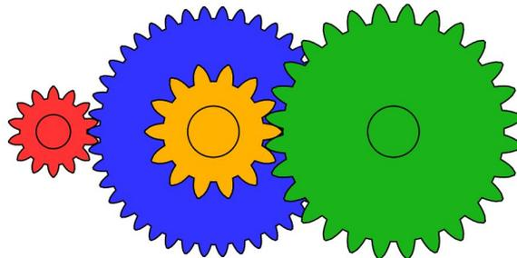
Das rote Stirnradgetriebe (Antriebsrad) dreht sich schneller als das grüne Stirnradgetriebe (Abtriebsrad). Es wird die Kraft jeweils von einem kleinen Antriebsrad auf ein größeres Abtriebsrad übertragen.
