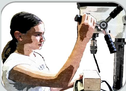
Das Werkzeug / der Bohrer sollte fachgerecht und sicher in die Maschine eingespannt werden!
