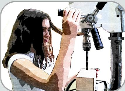
Lange Haare müssen beim Arbeiten mit Maschinen zusammengebunden werden!
