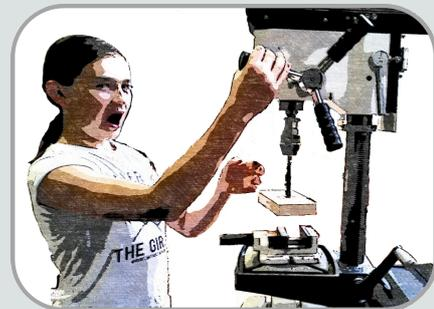
Nicht oder schlecht eingespannte Werkstücke können im Bohrer hängenbleiben und sich mitdrehen. Das mitdrehende Werkstück kann sich lösen und durch den Raum fliegen oder alleine durch das Mitdrehen schwere Verletzungen verursachen!
