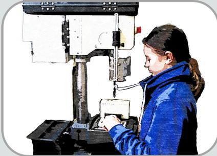
Langärmelige Kapuzenpullis und weite Kleidung sowie Hals- und Armketten können sich im Bohrer, Bohrspindel oder am Maschinenschraubstock verfangen und schwere Verletzungen verursachen!
