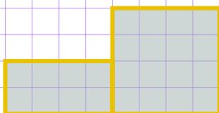
$$\begin{aligned} A_{\text{Vieleck}} &= A_{\text{Teilfläche 1}} + A_{\text{Teilfläche 2}} \\ &= (1\text{cm} \cdot 2\text{cm}) + (2\text{cm} \cdot 2\text{cm}) \\ &= 2\text{cm}^2 + 4\text{cm}^2 \\ &= \underline{\underline{6\text{cm}^2}} \end{aligned}$$
